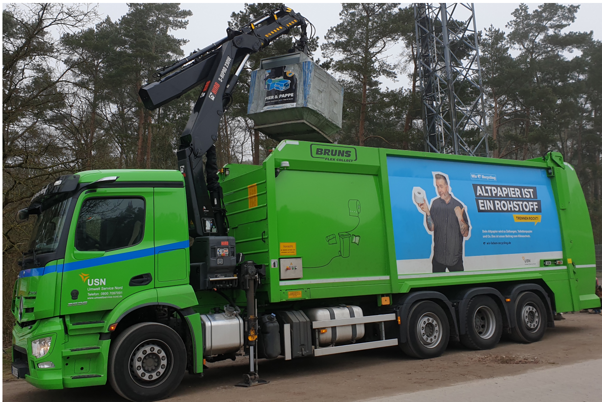
Abbildung 21: Fahrzeug mit Presse und Einfüllöffnung im vorderen Bereich, Sammelbehälter im hinteren Bereich, Kran mit Kontrolle über Containerdrehung
