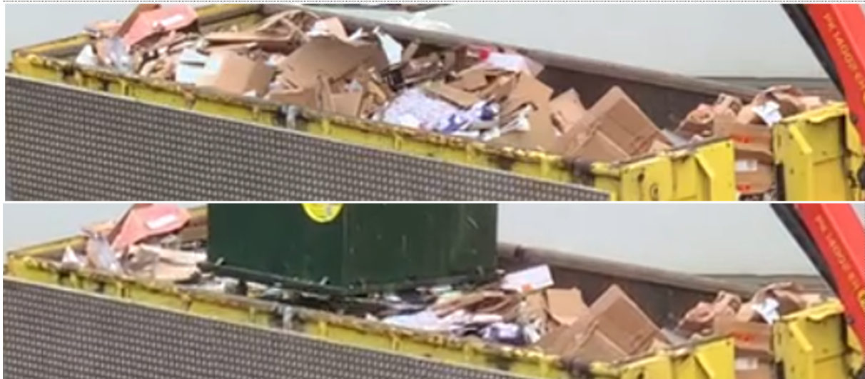
Abbildung 23: Vergleich der Verdichtung - vor und nach „Stampfen“ mit vollem Depotcontainer über 1 Minute
