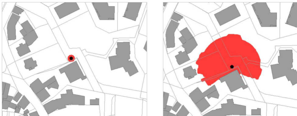
Abbildung 28: Kartenausschnitte mit Darstellung eines Konfliktbereichs für ein allgemeines Wohngebiet basierend auf Flascheneinwürfen in einen Depotcontainer (links) und Flascheneinwürfen mit anschließender Entleerung in ein Sammelfahrzeug (rechts)
