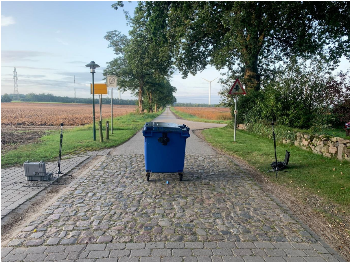
Abbildung 19: Messaufbau Müllbehälter (Rollgeräusch)
