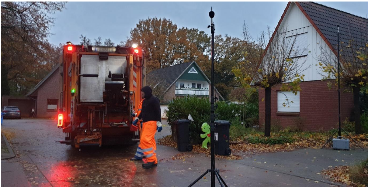
Abbildung 18: Messaufbau Müllbehälter (Entleerung)
