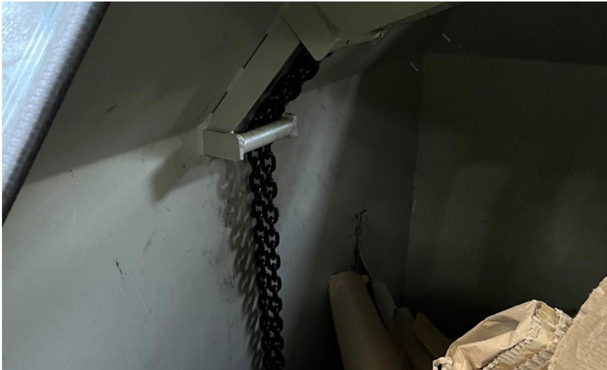
Abbildung 8: Ketten der Entleerungsmechanik in einem Altpapiercontainer (Typ 1)
