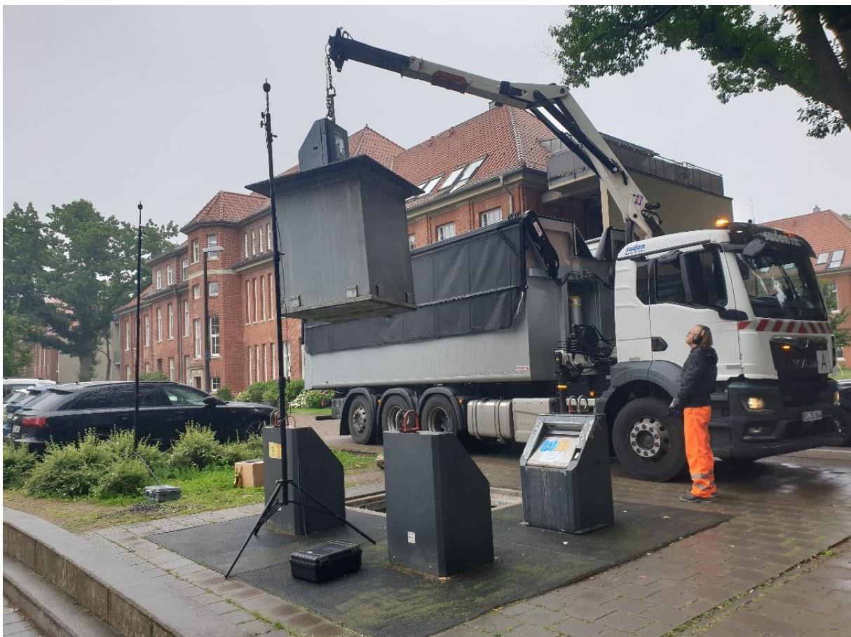
Abbildung 13: Messung eines Unterflurcontainers in einer Wohnstraße
