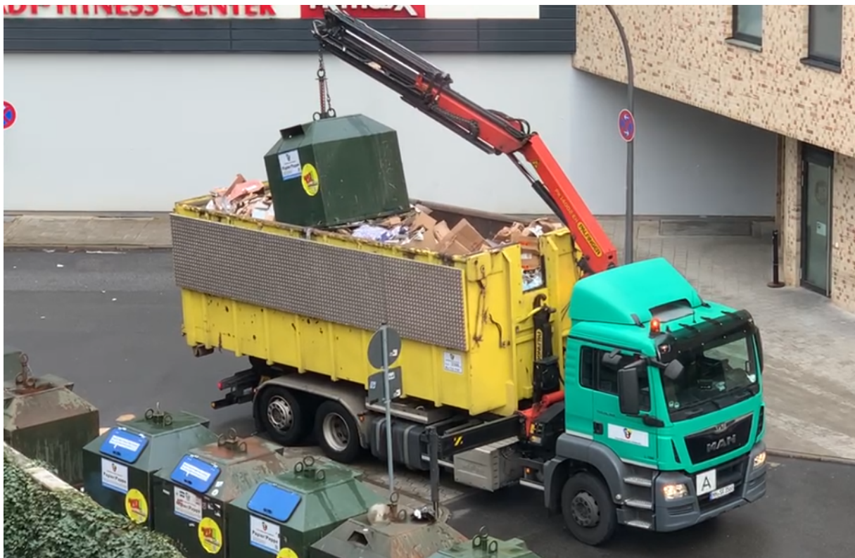
Abbildung 22: Verdichten mittels vollem Depotcontainer
