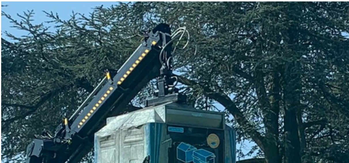
Abbildung 7: Fixiertes Aufnahmesystem mit starrer Anbindung Kran-Container
