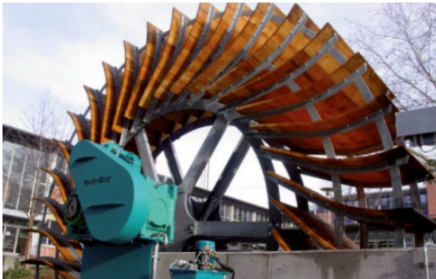
Abbildung 13: Modernes, mittelschlächtiges Wasserrad der Firma HydroWatt
