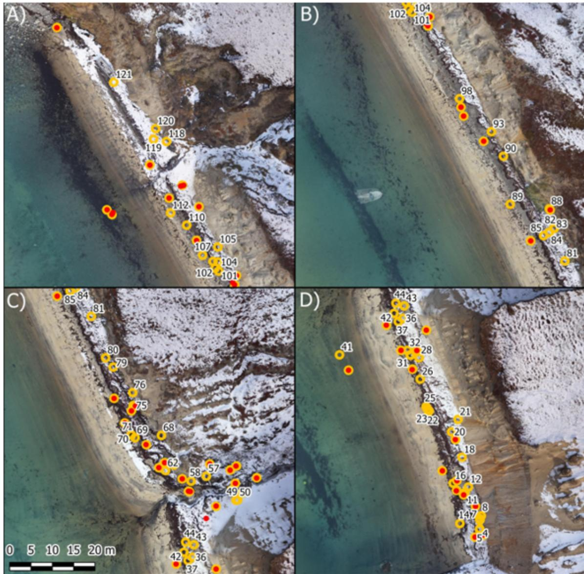
● Mittels GNSS vermessene Müllobjekte      ● Bei manueller Sichtung erfasste Müllobjekte
