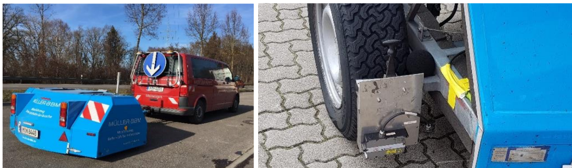
Abbildung 3: CPX-Messsystem mit Texturlaser
