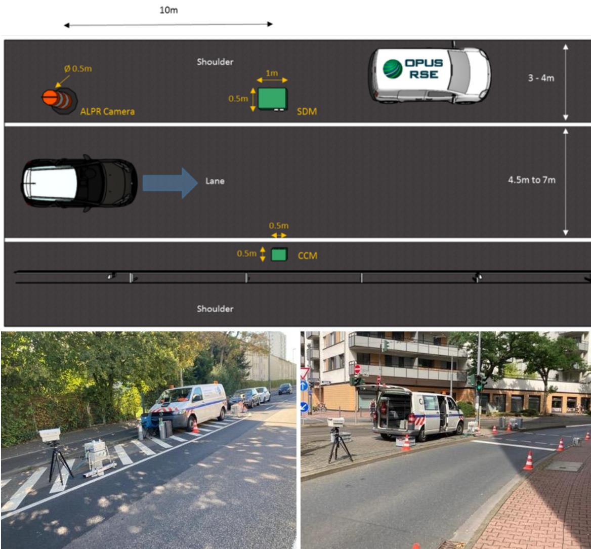
Schematischer Aufbau des Remote Sensing Messinstrumentes der Firma OPUS RSE (oben) und Foto von Messungen in Frankfurt am Main im Realbetrieb (unten)
