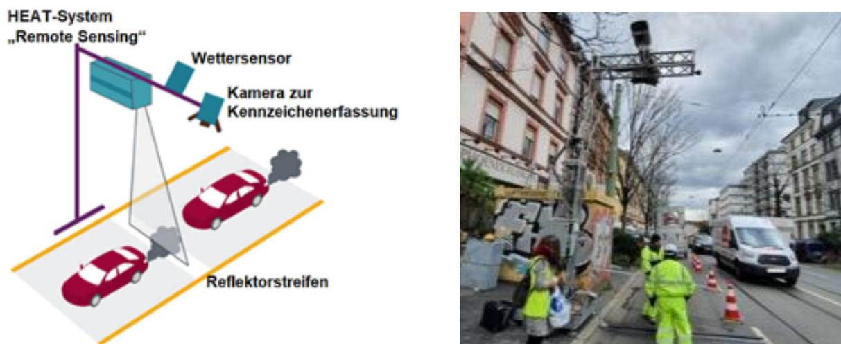
Schematischer Aufbau des Remote Sensing Messinstruments der Firma HEAT (links) und Foto von Messungen in Frankfurt am Main im Realbetrieb (rechts)
