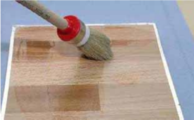
Abbildung 3-6: Pinselauftrag eines Lackes auf ein Holzträgermaterial
