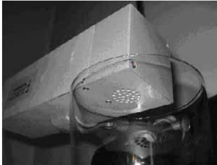
Abbildung 3-16: Sensorsystem Kamina beim Messen über einem Bewertungstrichter
