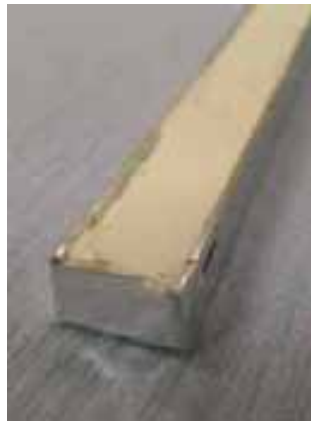
Abbildung 3-1: Einbringen von einer Dichtmasse in ein Aluminium-U-Profil
