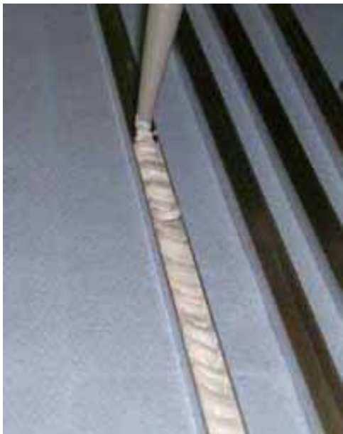
Abbildung 3-1: Einbringen von einer Dichtmasse in ein Aluminium-U-Profil
