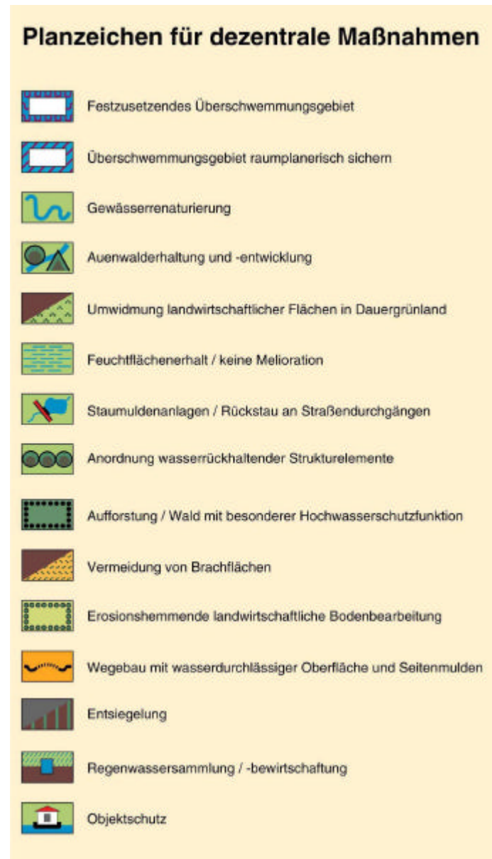
Abbildung 4: Maßnahmetypologie zur Hochwasserverminderung im "Informellen Plan"
