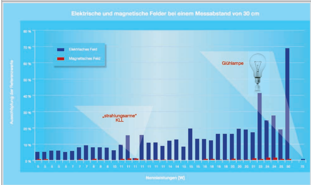
Abbildung 3: Ausschöpfung der Referenzwerte für das elektrische und magnetische Feld im Bereich der Betriebsfrequenz (einige zehn Kilohertz) von Kompaktleuchtstofflampen (KLL). Zum Vergleich wird die Ausschöpfung des Referenzwertes für das elektrische Feld einer Standardglühlampe bei 50 Hz gezeigt.
