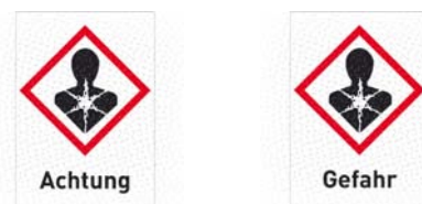
Abbildung 4: Signalworte unterscheiden zwischen der Stärke der Gefahr.
