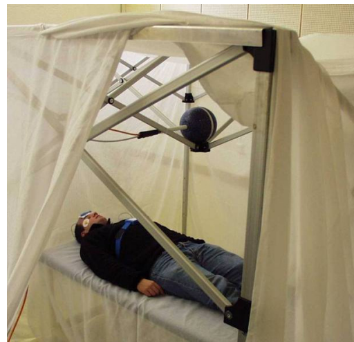
Abb. 2: Abschirmung der hochfrequenten elektromagnetischen Felder im häuslichen Umfeld mit Hilfe eines Baldachins.
