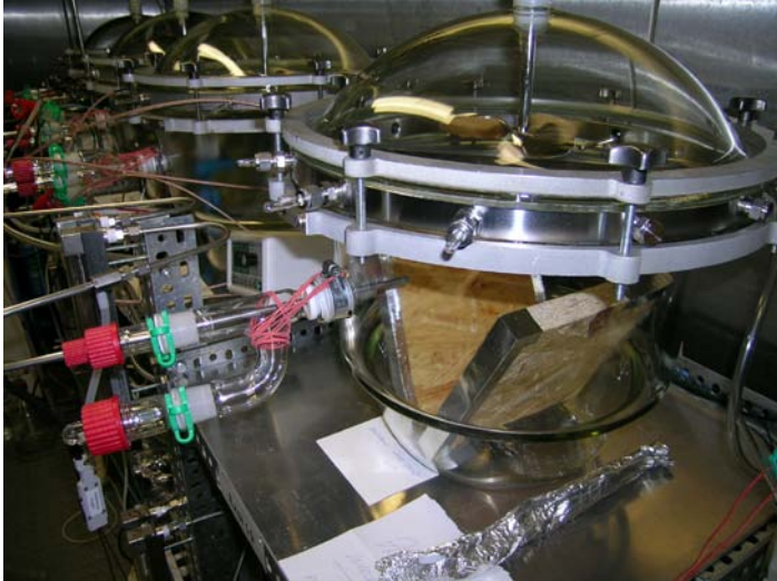
Abbildung 2: OSB-Platte in einer 24-Liter Emissionsprüfkammer
