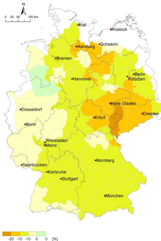
Abbildung 24: Wasserkraftpotenzial, Änderung 2055 gegenüber 2010 (2K-Szenario, mittlere Funktion); Jahresmittelwerte
