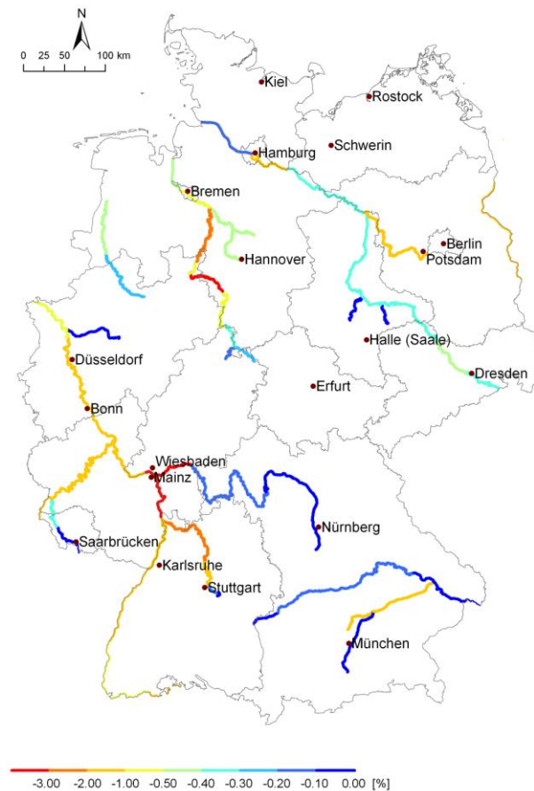
Abbildung 19: Auslastung thermischer Kraftwerke mit Durchlaufkühlung, Änderung 2055 gegenüber 2010 (2K-Szenario); Jahresmittelwerte
