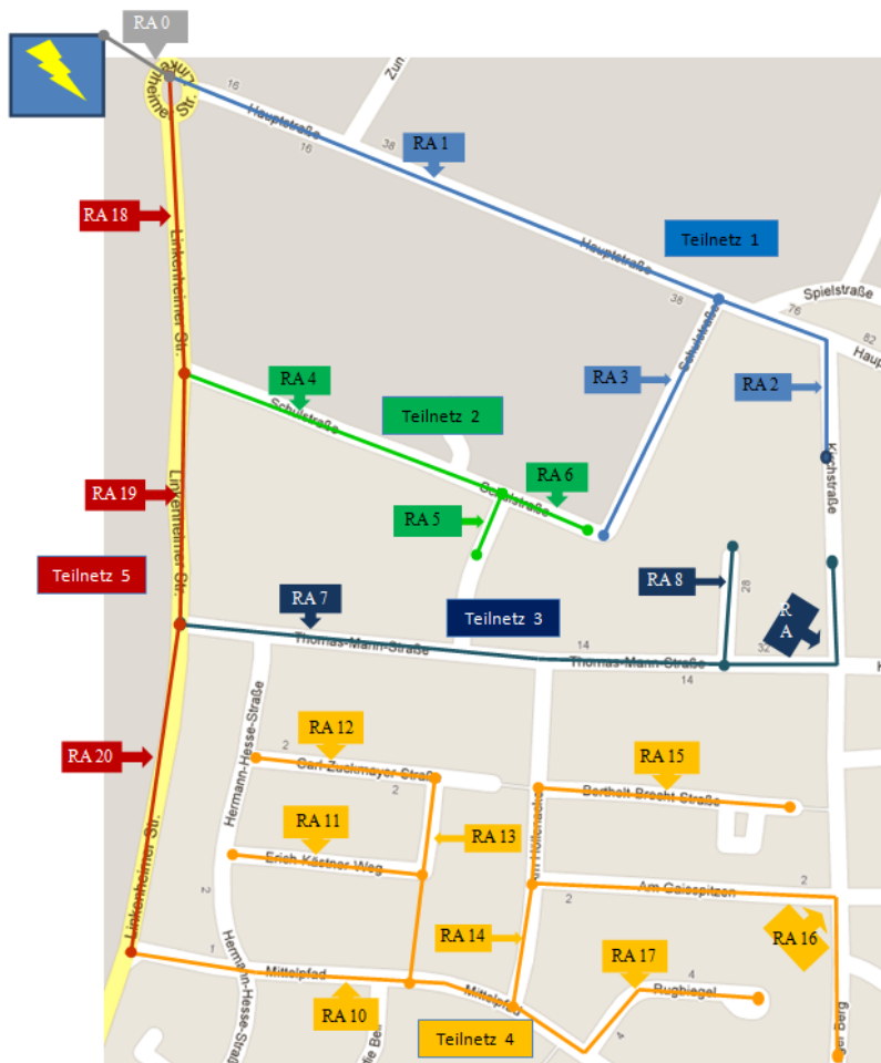
Abbildung 11: Topographie der Nahwärmenetze, bestehend aus fünf Teilnetzen (RA = Rohrabschnitt)
