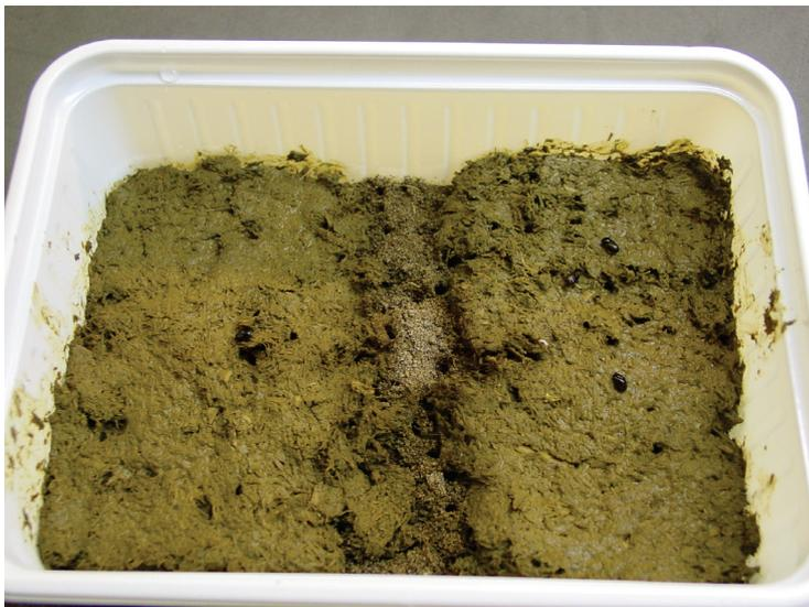
Abb. 10: Reproduktionstestgefäß mit LUFA 2.2 Boden unten und kontaminiertem Dung auf der Bodenoberfläche. Die eingesetzten adulten Käfer sind auf der Dungoberfläche zu erkennen
