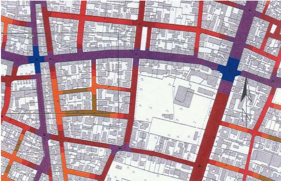
Abbildung 3: Bandartige Darstellung: breite Straßen treten optisch deutlicher in den Vordergrund als schmale Straßen (DIN 18005-Teil 2)
