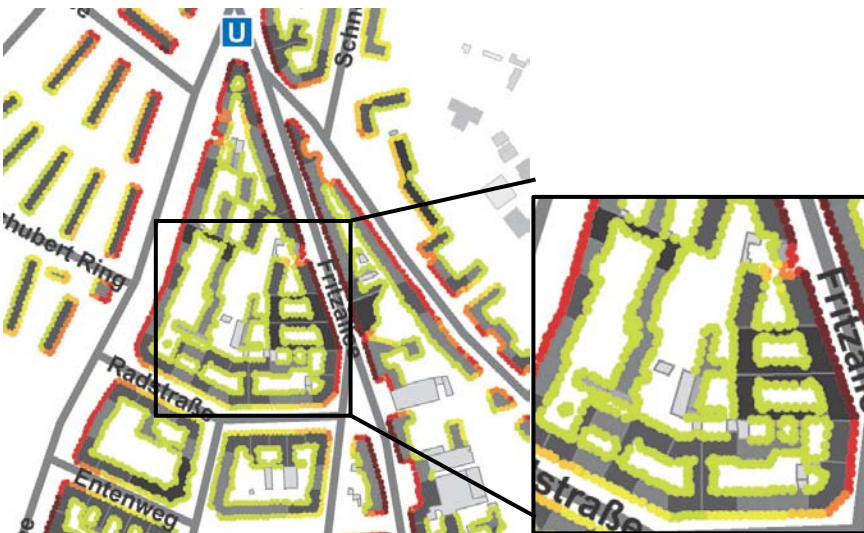
Abbildung 20: Punkthafte Darstellung des Fassadenpegels: die Punkte ergeben aufgrund der Datengrundlage ein sehr unruhiges Bild, dass aus kartographische Sicht nicht verwendbar ist. Die Alternative ist die Darstellung als Linien (siehe Abbildung 19). (eigene Graphik)
