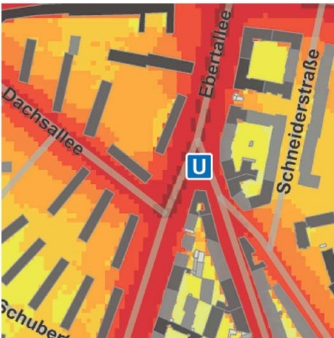
Abbildung 18: Die Lärmpegel werden als unterste Ebene in Vollton dargestellt, die Straßen können nach Bedarf transparent dargestellt werden. Anhand des Grautons der Gebäude lassen sich die Belastetenzahlen ablesen. (eigene Graphik)
