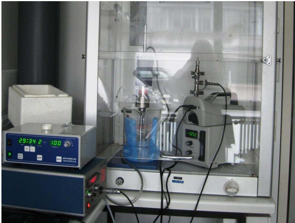
Abbildung 6: Aufbau der Messgeräte beim Homogenisieren mittels Ultraschall im Laborabzug
