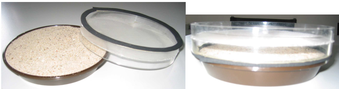
Abb. 3.5: Sand-BA und entsprechender Siebaufsatz mit schwarzer Schaumstoffdichtung
