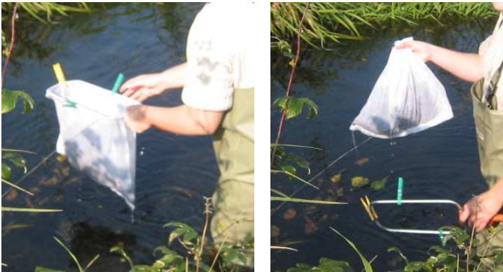
Abb. 3.3: Entnahme der BA mit schnell wechselbaren Keschernetzen
