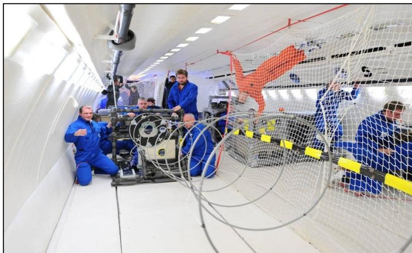
Abbildung 2: Entfaltete Antenne während des Parabelfluges
