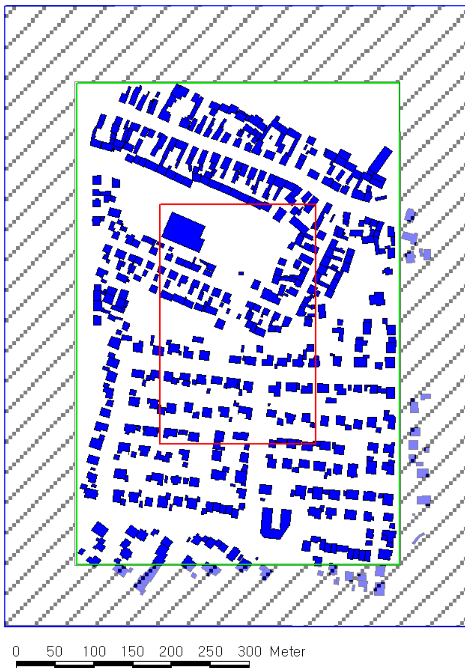
Bild 4-32 Ländliches Modellgebiet: blauer Umriss – Modellgebiet von 600 m x 800 m, schraffierter Bereich mit zusätzlichen Rauigkeitselementen versehen, grüner Umriss – Auswertebereich für das kleine ländliche Gebiet, roter Umriss – Auswertebereich für das große ländliche Gebiet
