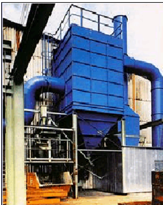
Abbildung 4.28: Foto einer industriellen Schlauchfilterkammer
