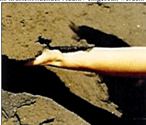
Abbildung 4.19: Krustenbildung auf der Oberfläche einer Halde [134, Corus, 1995]
