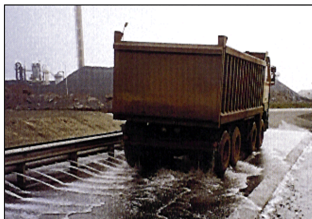
Abbildung 4.32: Ein Wasserbad in Verbindung mit fließendem Wasser für die Reifenlaufflächen [134, Corus, 1995]
