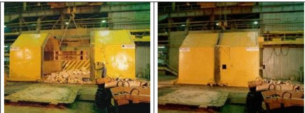
**Bild 4.17: Einhausung für ein Ausschlagrost für große Einzelgussstücke**
