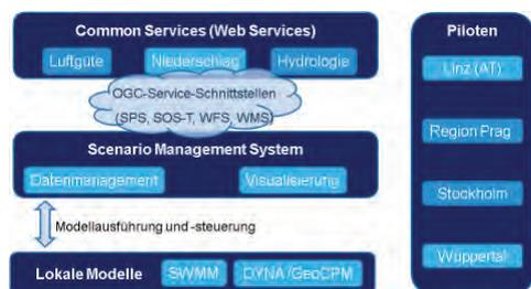
Bild 2: Aufbau des SUDPLAN-Tools und Pilotanwendungen
