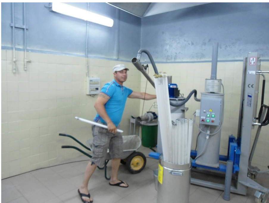
Фотография 6: Установка для утилизации люминесцентных трубок и энергосберегающих ламп
