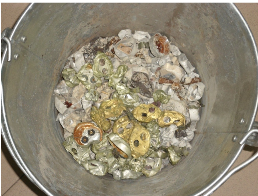
Фотография 7: Фракция после обработки: алюминиевые цоколи
