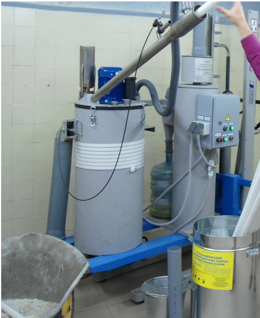
Рисунок 8: Установка для переработки люминесцентных и энергосберегающих ламп
