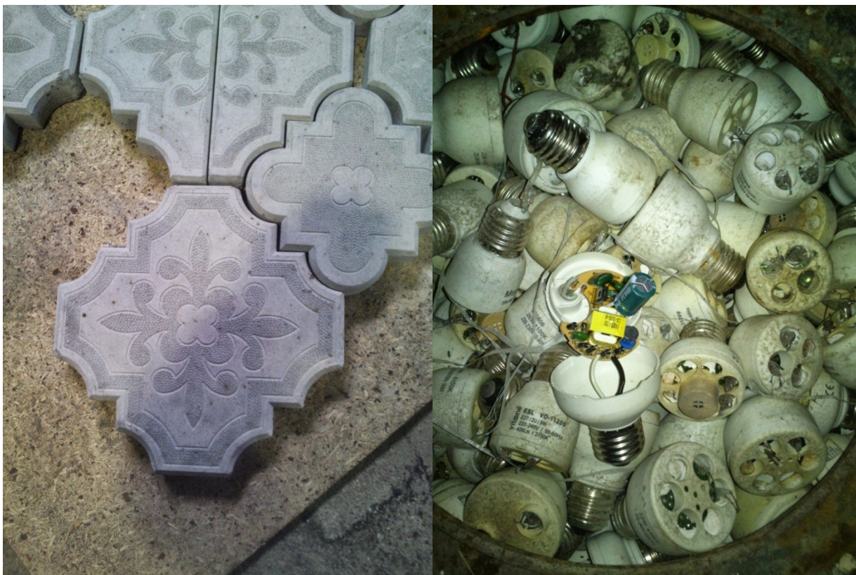
Рисунок 9: Материалы после обработки люминесцентных и энергосберегающих ламп
