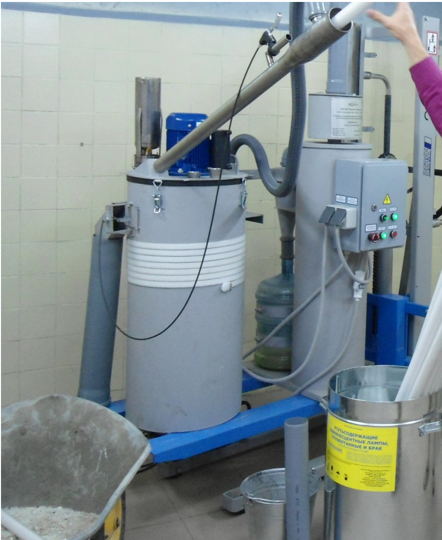
Фотография 5: Установка для утилизации люминесцентных трубок и энергосберегающих ламп
