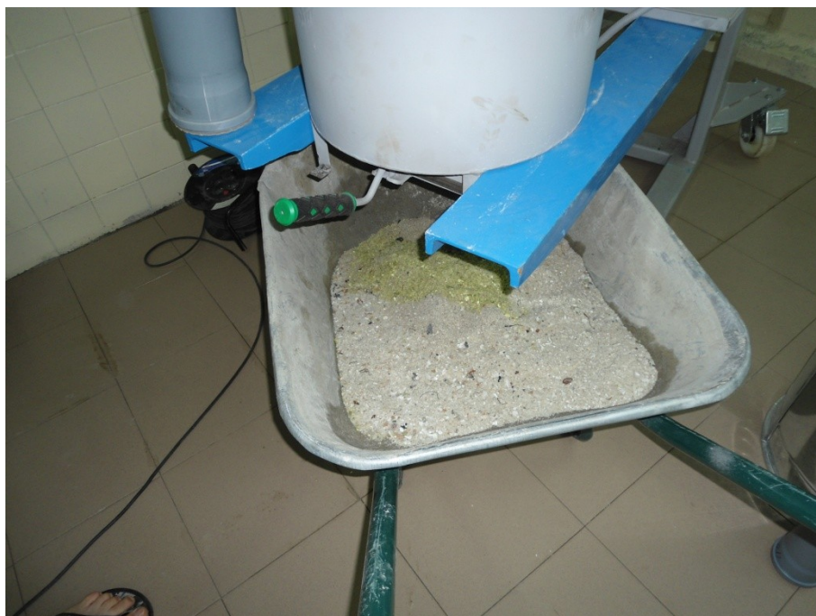
Фотография 8: Фракция после обработки: обеззараженная фракция стекло/светящийся порошок
