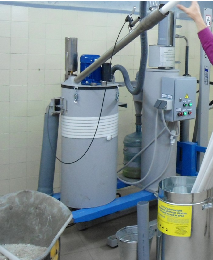
Фотография 3: Установка для переработки люминисцентных трубок и энергосберегающих ламп
