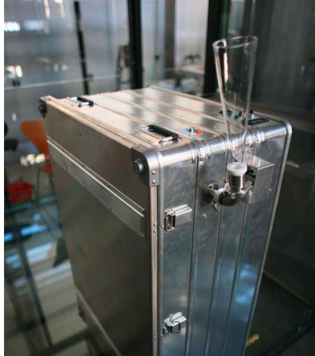
Bild 13 Das selbst entwickelte Probenahme- und Probendarbeitungsgerät Air Probe des Hermann-Rietschel-Instituts (HRI). An der rechten Seite ist ein Bewertungstrichter aus Glas erkennbar. Für die Geruchsmessung der gleichmäßig ausströmenden Luftprobe hält der Proband ihre Nase über den Trichter.
