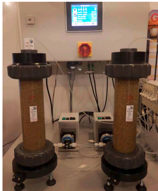
Bild 16 Prüfung eines körnigen Bauprodukts im Säulentest.
