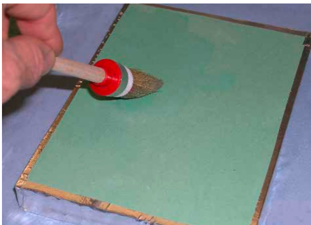
Bild 6 Pinselauftrag von Tiefengrund auf Gipskarton, die Schnittkanten der Gipskartonprobe sind mit selbstklebender Aluminiumfolie verschlossen.
