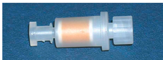
Bild 11 Kommerzielle Sammelkartusche, die DNPH auf einem Kieselgelträger enthält, für die Adsorption von Aldehyden und Ketonen.
