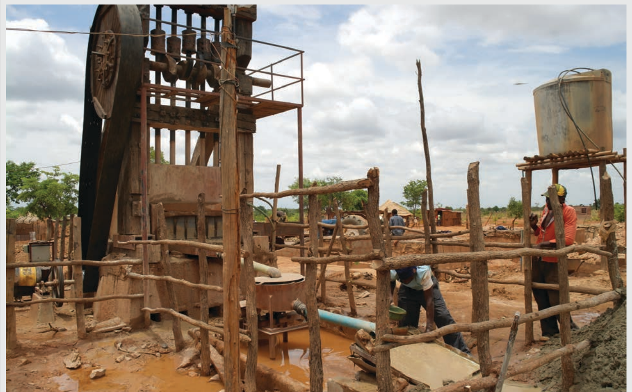
Abbildung 4: Gesteinsmühle mit Zentrifuge und Kupferplatte. Foto: Muschack 2013, Simbabwe.
