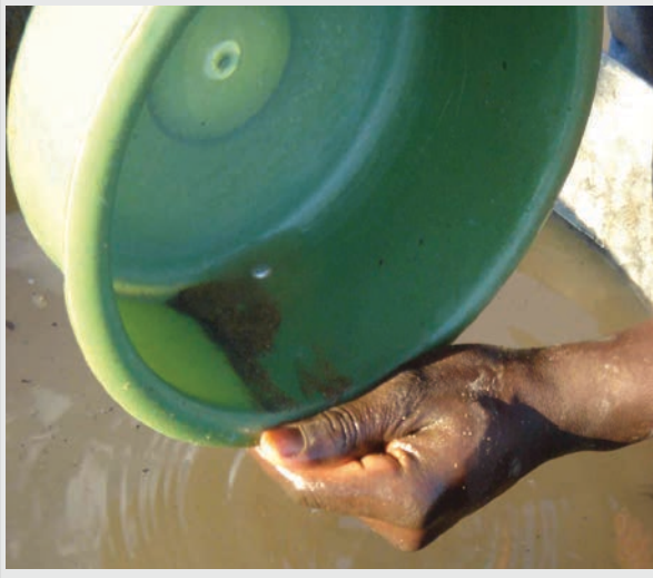
Abbildung 3: Goldwaschteller mit Erzkonzentrat und Quecksilber. Foto: Böse-O'Reilly 2006, Simbabwe.
