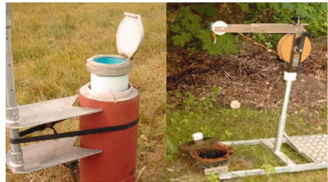
Abb. A-1-2: Für die Probenahme verwendete Seilwinde mit zwei verschiedenen Halterungskonstruktionen.
