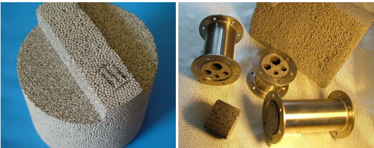
Abbildung 106: Links: mechanisch bearbeitete Metallische Hohlkugelstrukturen (MHKS); Rechts: Einsatz von MHKS innerhalb von Absorptionsschalldämpfern
