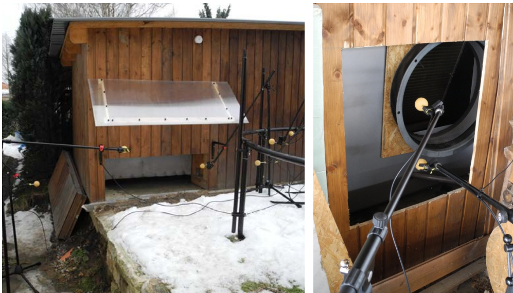
Abbildung 69: Messaufbau zur schalltechnischen Bestimmung der spektralen Schalleistung einer LWWP in Kompaktbauweise für Innen-/Außenaufstellung mit zusätzlicher Einhausung (Eigenbau) in situ
