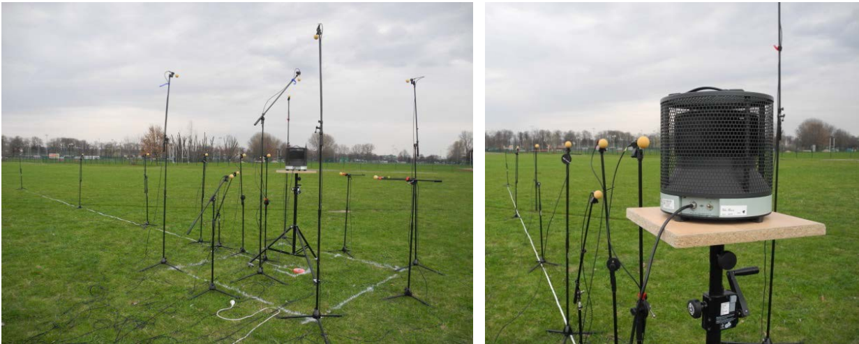
Abbildung 76: Messaufbau zur Bestimmung des A-bewerteten Schalleistungspegels der Vergleichsschallquelle sowie des A-bewerteten Schalldruckpegels im Abstand von 0,5 m bis 16 m zur Vergleichsschallquelle
