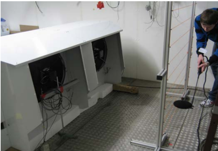
Abbildung 138: Messtechnische Bestimmung der Schalleistung an einem Verdampfer durch Anwendung des Schallintensitäts-Verfahrens mit kontinuierlicher Abtastung in der Klimazelle
