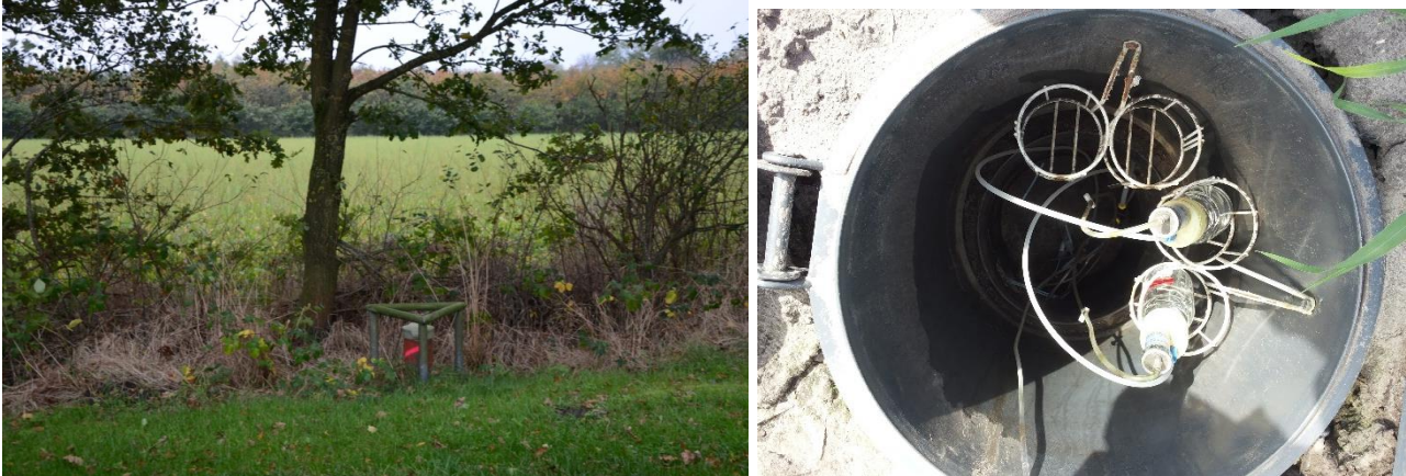
Abbildung 11: NLWKN-Messstelle Markhausen-BDF (Foto links: Messstelle des NLWKN; Foto rechts: Sickerwassersammler des LBEG zur Gewinnung von Proben aus der ungesättigten Zone)
