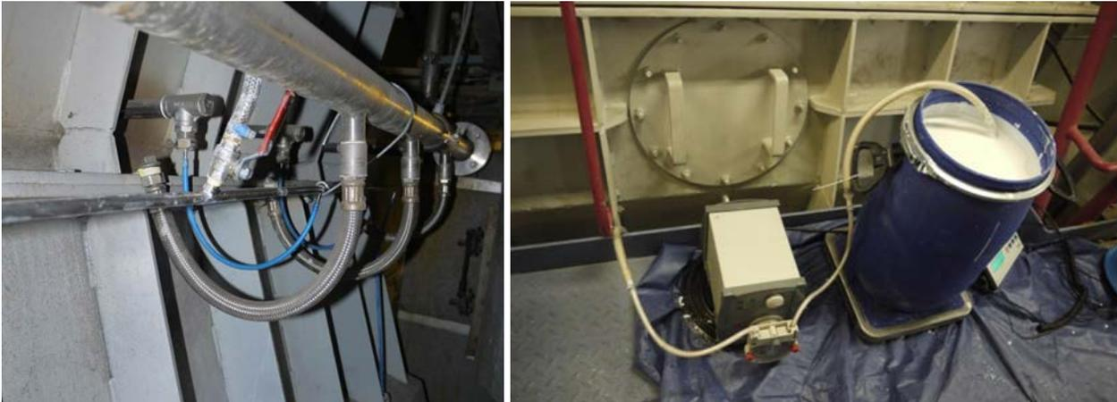
Eindüsung des Nanomaterials, Links: Löschwasserdüsen zur Einbringung der Titandioxid-Suspension in den Brennstofftrichter, Rechts: Vorrichtung zur Einbringung der Nanomaterial-Suspension mit Vorlagebehälter, Waage und Schlauchpumpe
