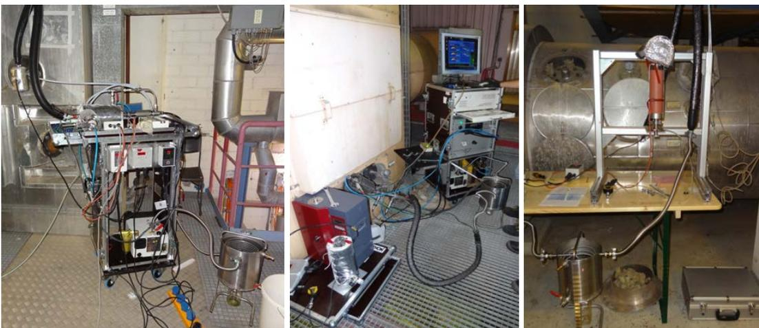
Messstellen Abgasbeprobung, Links: Messstelle nach Kessel, Mitte: nach Zyklon, Rechts: vor Kamin
