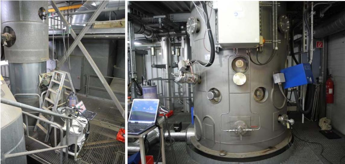
Messstellen Abgasbepröbung: Messstelle 2 nach E-Filter (links); Messstelle 3 vor Kamin (rechts).
