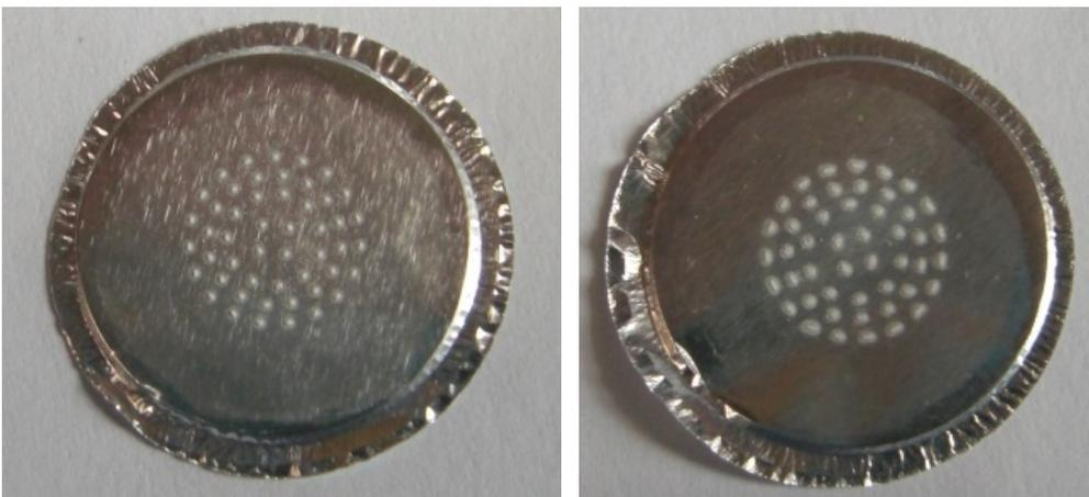
Impaktorstufen 6 und 7 nach der erneuten Probemessung mit angepasster Messzeit am GKS, Messstelle nach Zyklon
