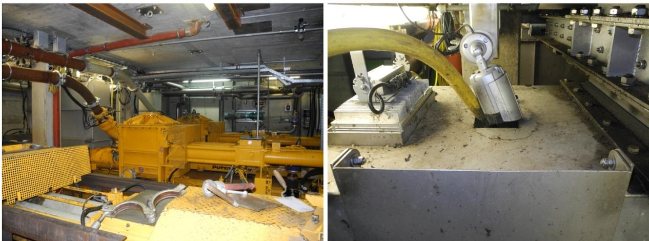
Einbringung TiO<sub>2</sub> Material: Feststoffpumpe (links); Einbringung TiO<sub>2</sub> Material (rechts).
