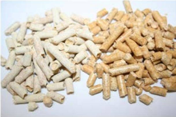
Holzpellets mit (l.) und ohne oberflächlicher nanoTiO<sub>2</sub>-Auftragung (r.)
