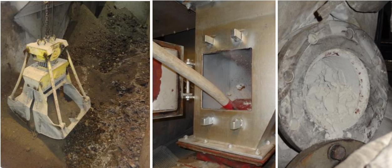
Probenahmestellen Rückstände: Links: Probenahmestelle Schlacke, Mitte: Kesselasche, Rechts: Gewebefilterrückstand
