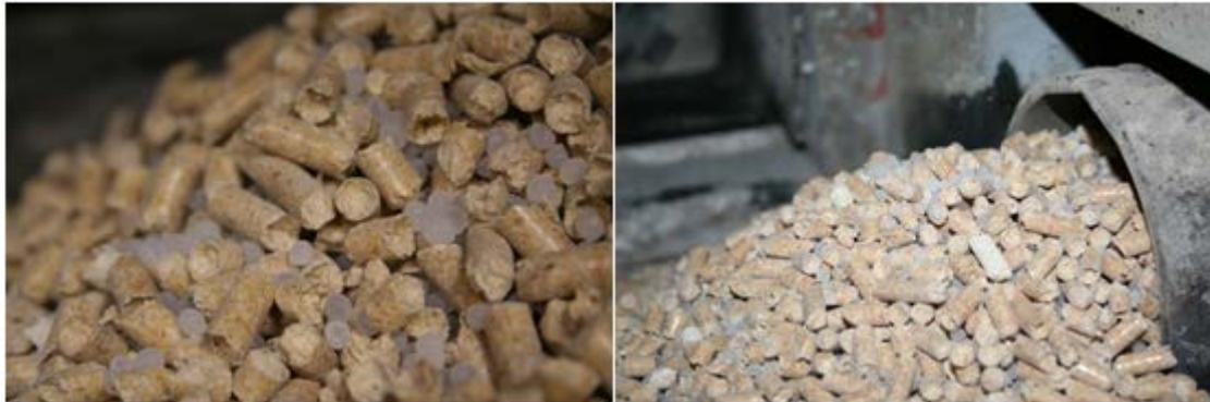
Gemisch aus Holzpellets und nanoTiO<sub>2</sub>-haltigem Kunststoffgranulat bei Förderversuch in Technikumsanlage
