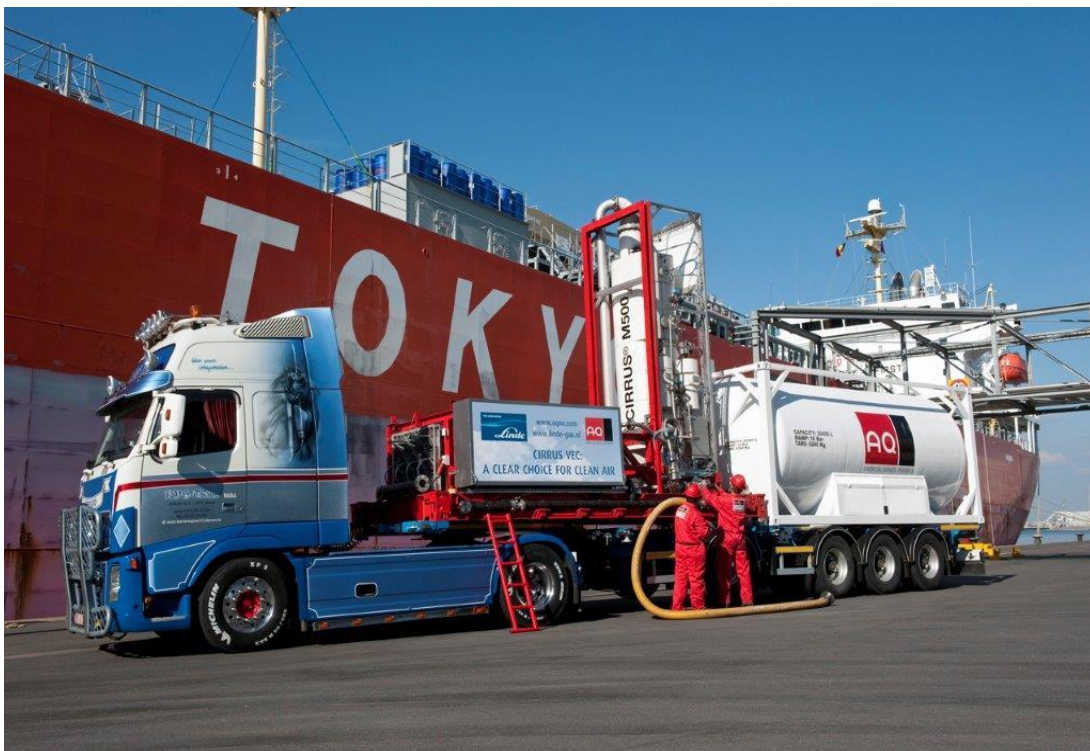
Abbildung 19: AQ Kryo-Kondensationsanlage im Hafen von Antwerpen (Foto: AQ Chemical Service Provider)
