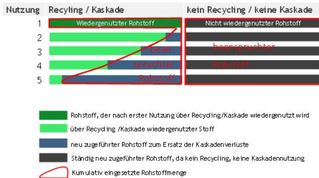
Abbildung 5: Schematische Darstellung des kumulativen Rohstoffverbrauchs bei wiedergenutztem und nicht wiedergenutztem Rohstoff.
