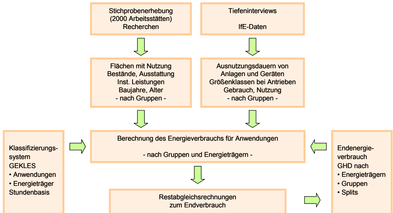
Abbildung 2-6: Schema zur Ermittlung einer Energieanwendungsbilanz für den GHD-Sektor
