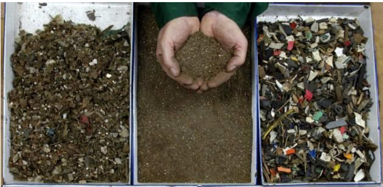
Abbildung 40: Stoffströme aus der Aufbereitung der Schredderleichtfraktion
