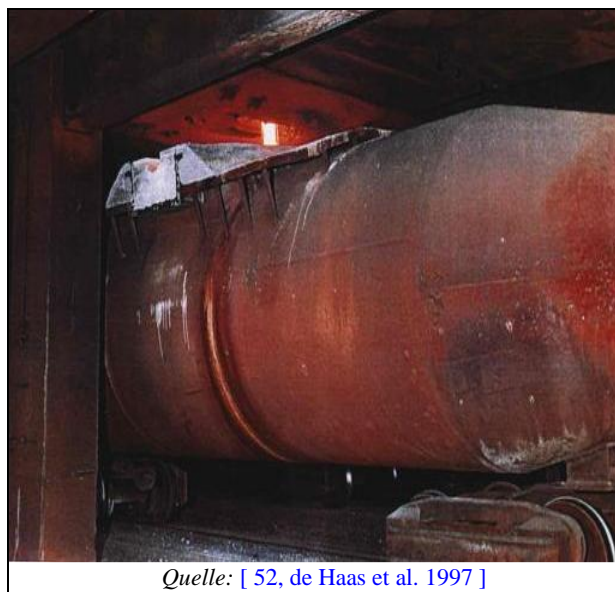
Abbildung 6.16: Staubunterdrückung durch Inertgas bei der Befüllung einer Torpedopfanne mit Roheisen
