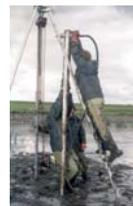
Abb. 2: Probenahme von Sedimentkernen zur Rückstandsanalytik.
