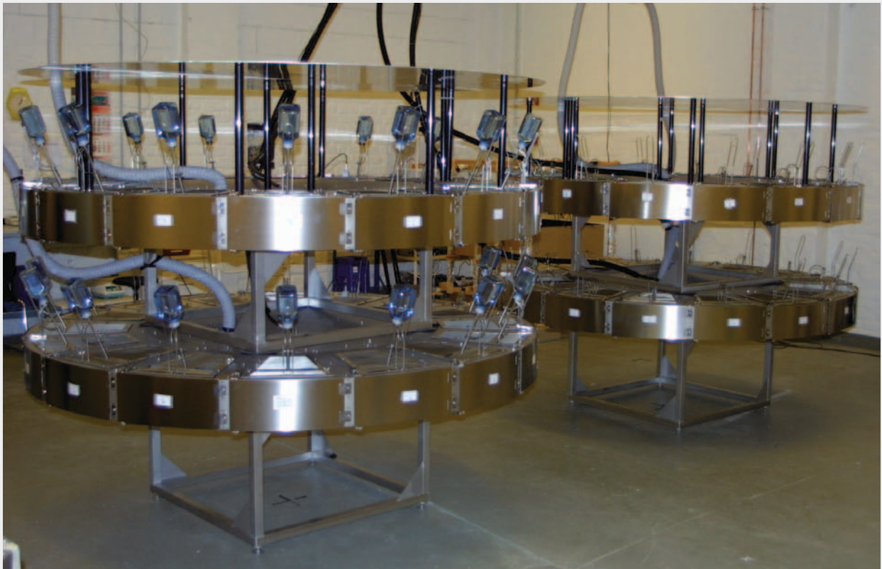
Abbildung 1: Beispiel einer gut definierten Anlage zur Exposition von Mäusen mit hochfrequenten elektromagnetischen Feldern des Mobilfunks, die in der Studie von Sommer et al. (2009) verwendet wurde. Die Anlage besteht aus vier Einheiten. Jede Einheit enthält 16 Käfige. Quelle: Jacobs University Bremen.
